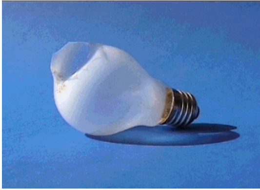
Abb. 5.1: Glühbirne aus unserer Mikrowelle. Die Hitze des entstandenen Plasmas hat das Glas durchgeschmolzen.
