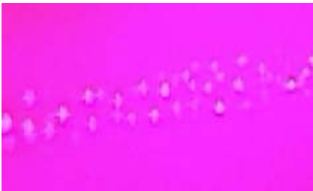
Abb. 9.4: Ein Plasmakristall aus dem Toner eines Laserdruckers
