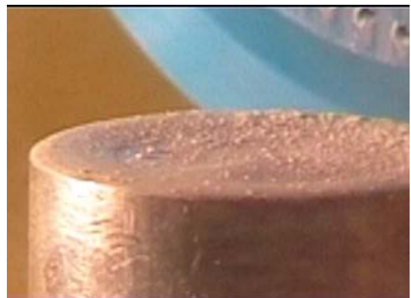
Abb. 6.12: Elektrode mit Mikropartikeln
