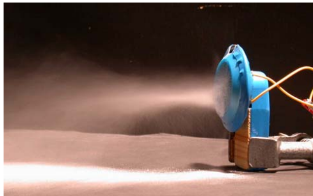
Abb. 6.10: Staubausstöß unter „normalem“ Luftdruck
