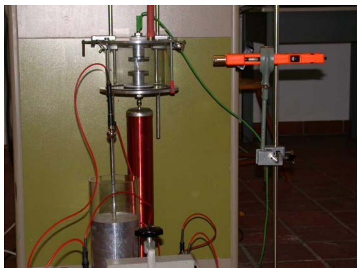
Abb. 6.4: Unser Versuchsaufbau: Rechts: die Laser-Wasserwaage, Links: Plasmakammer und Teslatrafo
