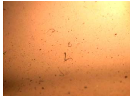
Abb. 6.5.2: Ergebnis der Rußbildung mit medizinischer Kohle als Elektrode
