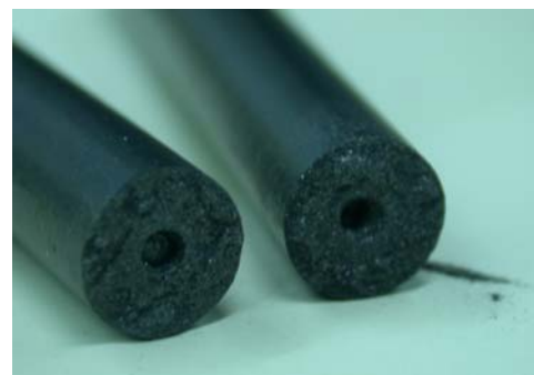
Abb. 8.1: In der Mitte unserer neuen Graphitstäbe befindet sich das Katalysatorgemisch
