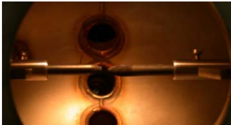
Abb. 6.3.1: Kohlestäbe als Elektroden in unserer Kammer
