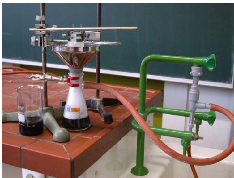
Abb. 10: Apparatur zur Herstellung eines Bucky-Papers
