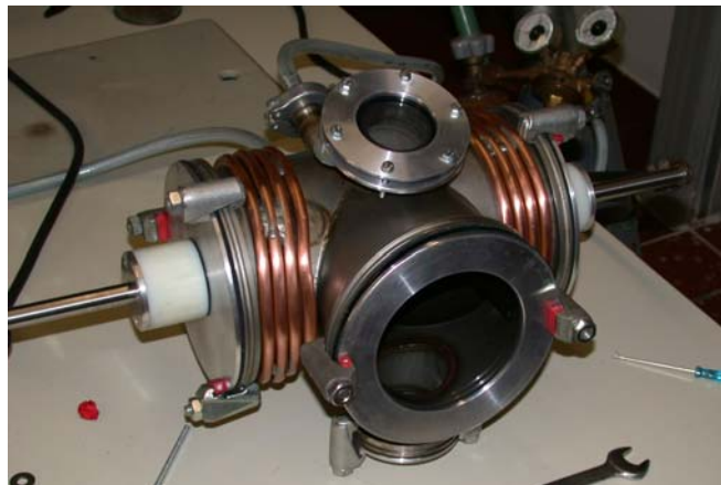
Abb. 4: Unsere fertige Lichtbogenkammer mit Kupferrohren zur Kühlung
