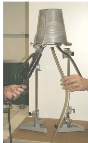
Abb. 6: Herstellung von Kohlenstoffnanoröhrchen in einem Eimer
