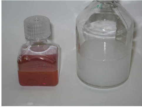
Abb. 4.4 Im linken Gefäß sind die 80nm großen Goldkugeln. Im rechten Gefäß sind die SiO 2 -Kugeln
