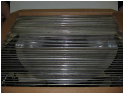
Abb. 4.1 Das Hertz'sche Gitter ist parallel zur Schwingungsebene ausgerichtet.
