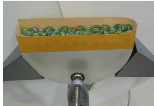
Abb. 3.11 Auskopplung der Mikrowellen aus dem Nahfeld mittels Glasmurmeln.
