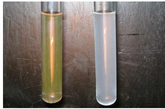
Abb. 4.5 Im linken Gefäß sind die 80nm großen Goldkugeln. Im rechten Gefäß sind die SiO 2 -Kugeln (je mit Wasser verdünnt 1:10)
