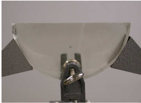
Abb. 3.10 Totalreflexion von Mikrowellen im eingespannten Halbzylinder.
