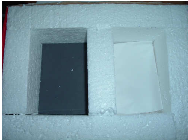
Abb. 5.2 Mein Sonnenkollektor zum Vergleich von schwarzen und weißen Oberflächen
