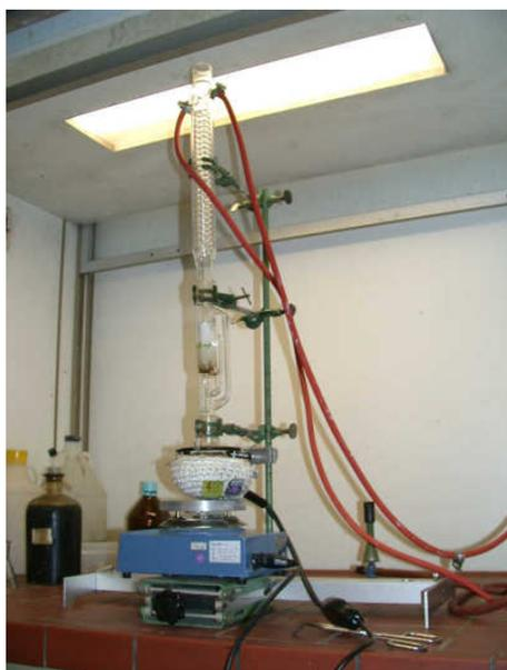
Abbildung 13: Extraktionsapparatur
