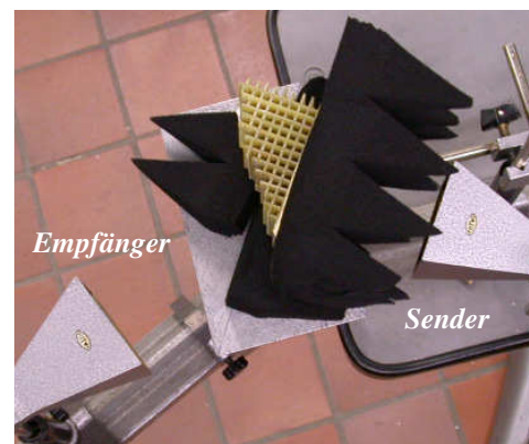
Abb. 1.2 Messung mit Mikrowellen an unserem Metamaterialprisma
