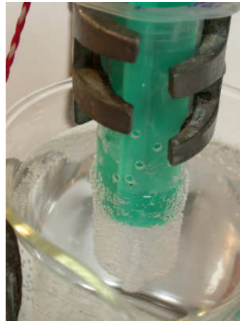
Abb. 7.4 Die Spritze in der Nahaufnahme. Man erkennt deutlich die Löcher in der Spritze, durch die das Wasser hinein fließt.
