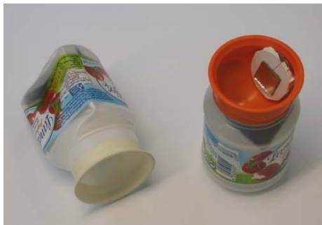
Abbildung 7.1 Unsere Golay-Zelle nach einer Nacht gefüllt mit CO 2
