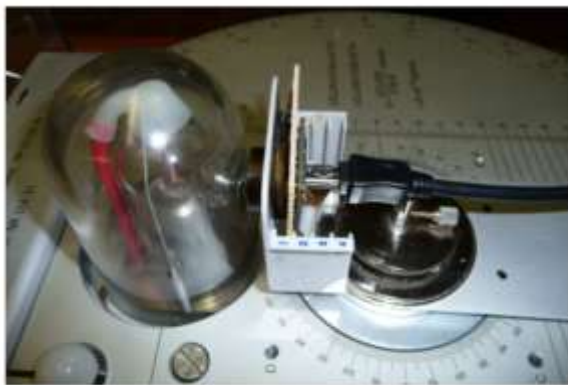
Abbildung 7. 2: Apparatur zur Befestigung des CCD-Sensors
