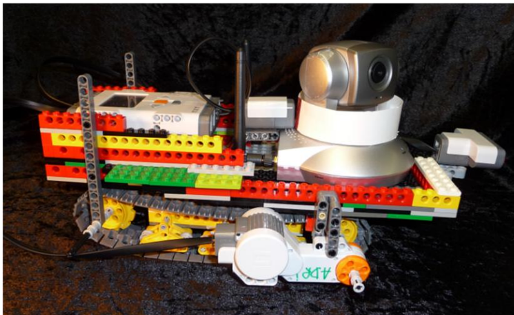
Abb. 7: Die SHR2.2-Version unseres Schulhilfsroboters mit Ketten und interner Intelligenz
