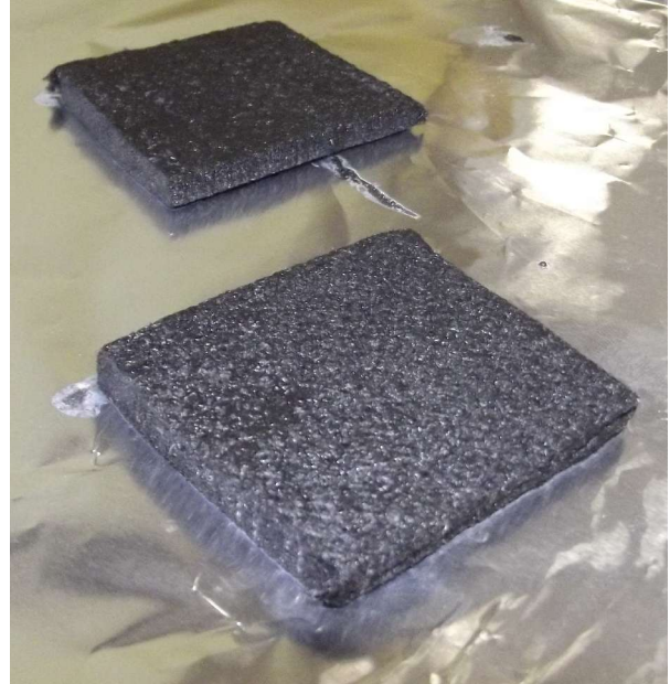
Abb.3.4: Die Filzelektroden auf der Heizplatte
