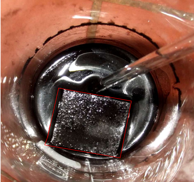
Abb.3.3: Elektrode (rot eingerahmt) in der Graphenlösung
