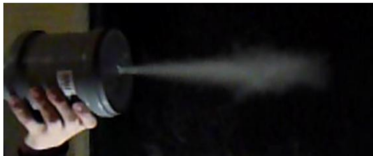
Abb. 4.1: Strahlstabilisierung durch Verwirbelung des Nebels an einer kleinen Öffnung.
