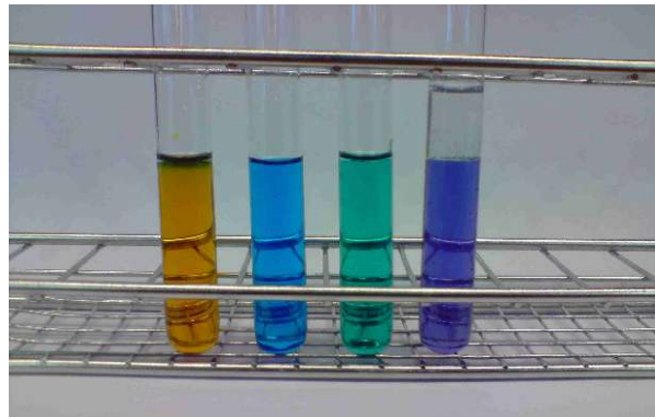
Abb. 3.1.2: Die selbst hergestellten vier Oxidationsstufen des Vanadiums: v.l.n.r. V(V), V(IV), V(III), V(II)
