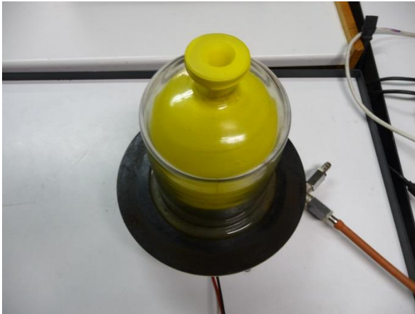
Abb. 7.1: Vakuumblocke als Befüllungsanlage für die Ballons
