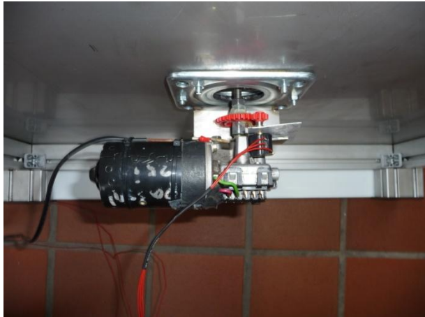
Abb. 5.4: Motor für die Drehung mit Potentiometer
