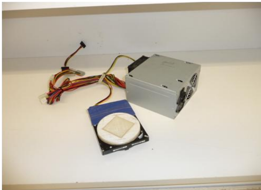
Abb. 4.7: Mein Spin Coater (umgebaute Festplatte) mit Netzteil
