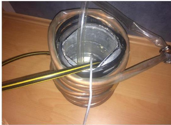
Abb. 6.1: Der verbesserte Gegenstromkühler mit zusätzlichem
