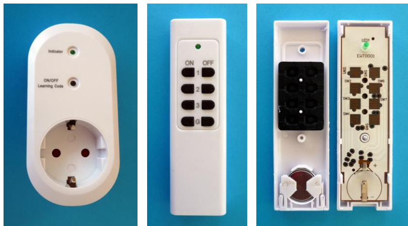
Abb. 6.1: Funksteckdose mit geschlossener und geöffneter Fernbedienung
