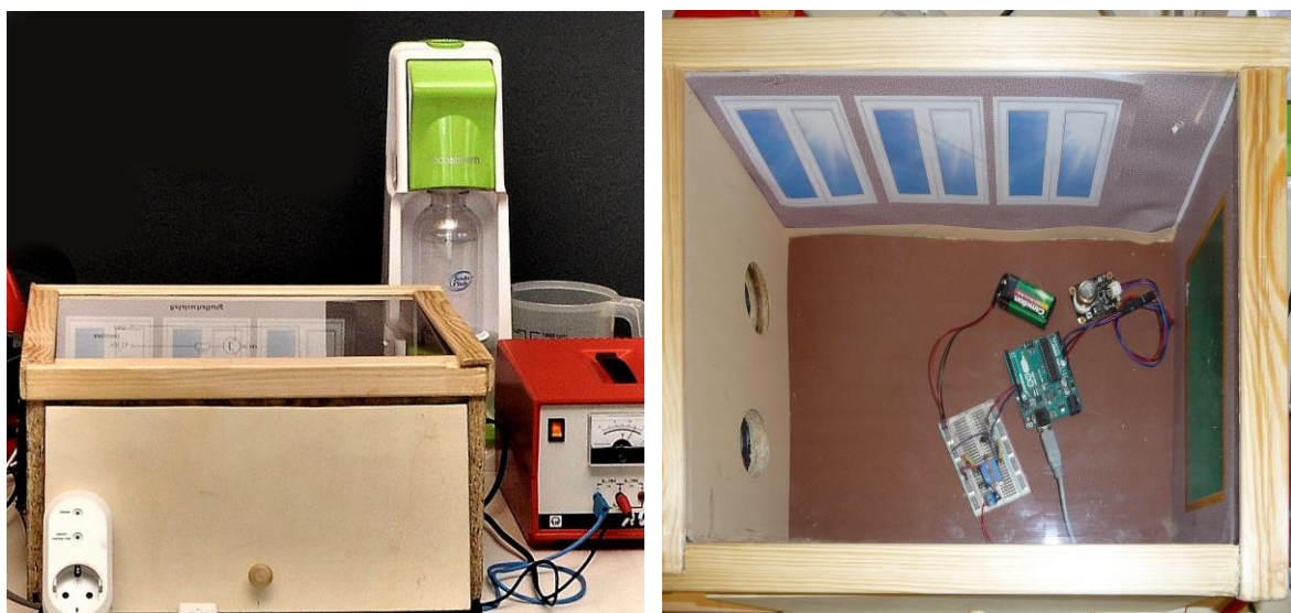
Abb. 6.7: Mein Modellklassenraum. Hinten im linken Bild ist der CO 2 -Sprudler zu sehen. Im rechten Bild sind die Öffnungen für die beiden Lüfter zu sehen.
