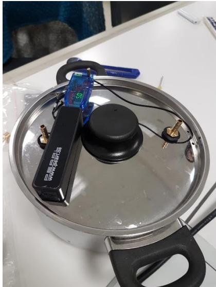
Abbildung 6: Energieversorgung der Pumpe
