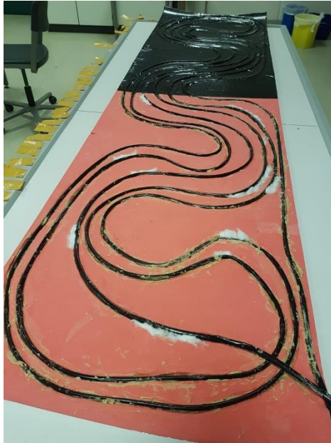
Abbildung 2: Matte mit eingelassenem PVC-Schlauch, halb in Isolierband eingefasst
