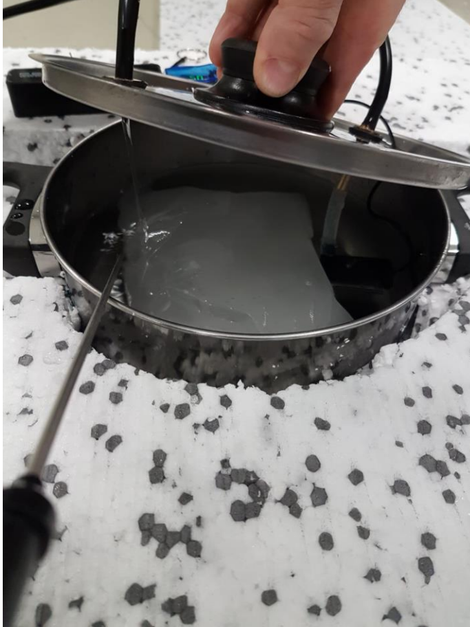
Abbildung 3: geschlossener Wasserkreislauf mit aktiviertem Wärmepad und Thermometer
