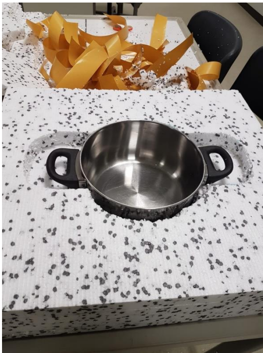
Abbildung 5: Styropor®fassung als Isolierung des Topfes
