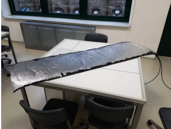
Abbildung 4: Silberfolie unter der Matte als Isolierschicht
